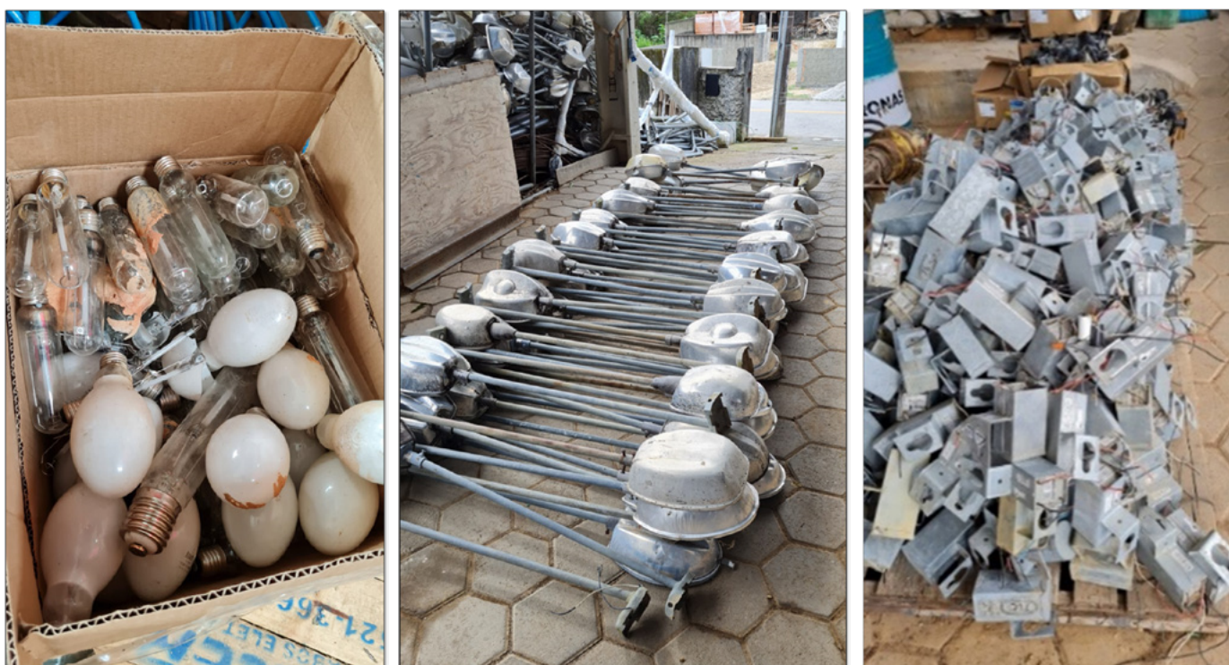
Figura 6. Descarte de lâmpadas, luminárias e reatores.
